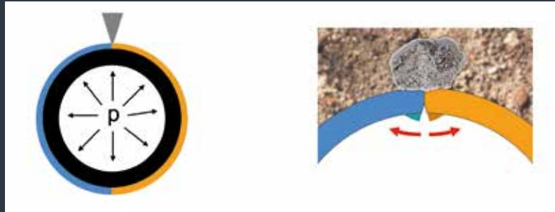
Au cours de l'installation ou de la manutention, des charges ponctuelles avec des incisions sur la paroi du tuyau peuvent survenir provoquant l'effet SCG (Slow Crack Growth).
