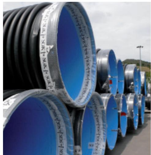
**1** rimozione delle protezioni plastiche dalle estremità e verifica di assenza di eventuali difetti o danneggiamenti
