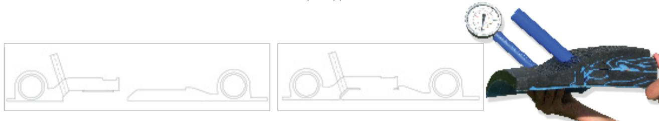
Tale tipo di collaudo consente una valida e attendibile verifica di efficienza di tenuta delle giunzioni elettrosaldate dopo poste in opera, per il quale è necessario l'utilizzo di un solo compressore d'aria (o limitate quantità di acqua).
