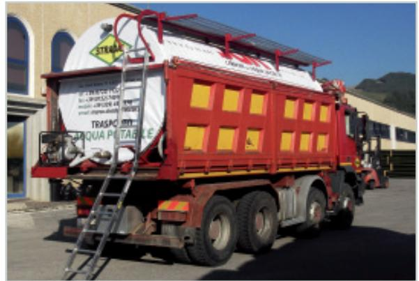
Cisterna DN 2000 con sistemi antionda e strutture esterne di accesso a norma
