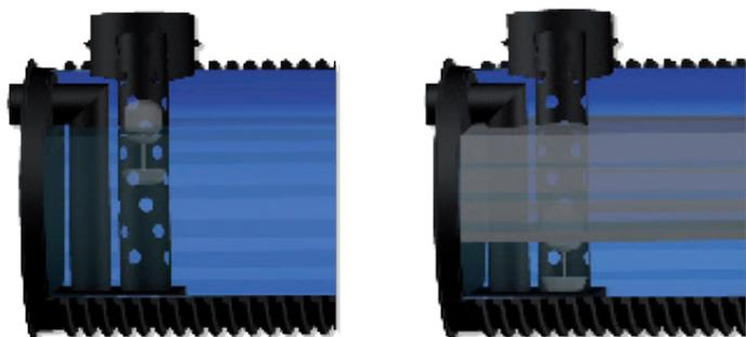
Valvola otturatrice di sicurezza a galleggiante. La valvola si attiva sfruttando la differenza di densità dei liquidi leggeri per evitarne lo scarico incontrollato, soprattutto in caso di sversamento accidentale di liquidi a basso peso specifico.
