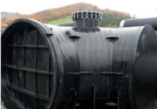
Curva a tre settori DN 2000 mm con ispezione collaudata in pressione a 4 bar
