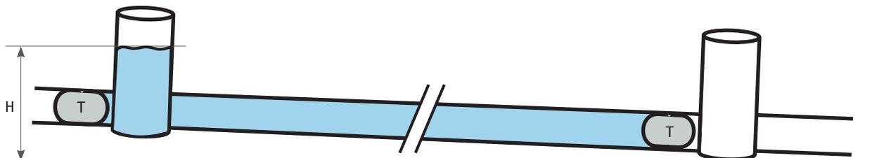
T tappo (sfera / pallone) - H piezometrica determinante il valore della pressione ( $H_{max} \geq 5mm$ )
