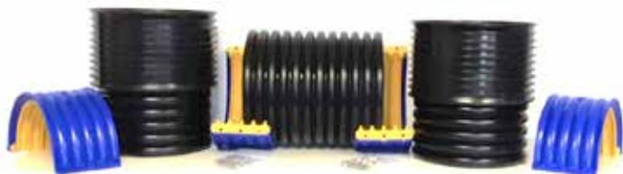
El Kit de reparación Universal se compone de 2 tramos de tubería SN16 conectada a 2 manguitos universales, 2 kits CorPress (con tornillería incluida) y 1 tramo central de tubo MEGAPIPE SN16 de alta resistencia mecánica.
