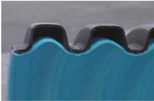
La tubería **SLOW FLOW** está especialmente diseñada para canalizaciones en terrenos con fuertes pendientes: el diseño estructural de la pared interior (con **macro rugosidades artificiales** tipo AMR: Artificial Macro Roughness) permite reducir la velocidad del fluido y mantenerla dentro de los márgenes de seguridad establecidos. Esto supone un importante ahorro en costes de instalación al eliminar o reducir el número de pozos de salto.
