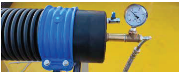
VÍDEO PRUEBA DE PRESIÓN Duración 2' 45 segundos
