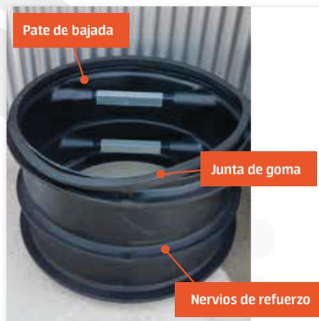
El T-MÓDULOS se utiliza en obra para tuberías de grandes diámetros (DN 1000 y DN1200 mm). En este caso en lugar de que la conducción principal entre en el pozo, es el pozo el que se construye sobre la tubería formando un sistema compacto que no afecta al flujo hidráulico.
