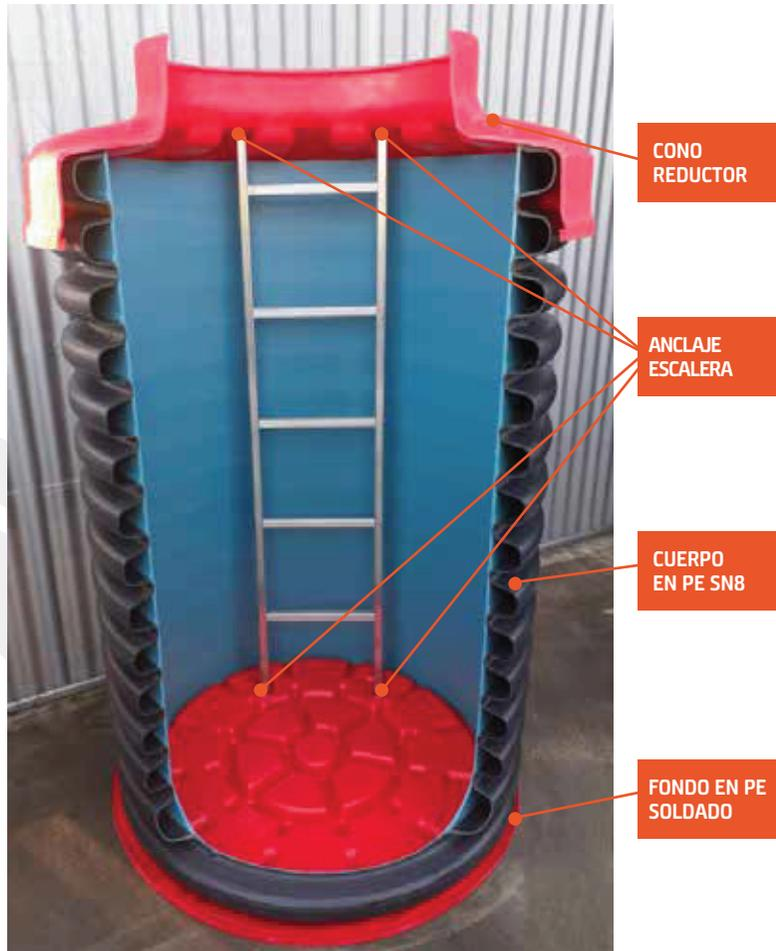
Los pozos de registro Rock se fabrican con tubería corrugada HDPE MAGNUM en diámetro nominal DN 1000 y 1200 mm que constituye la estructura del cuerpo del pozo.
