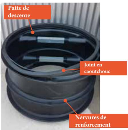
Les T-Módulos sont utilisés sur site pour des conduites de grand diamètre (DN 1000 et DN 1200mm). Dans ce cas, au lieu que la canalisation principale pénètre dans les regards, il est construit au dessus du tuyau, formant un système compact qui n'affecte pas le flux hydraulique.
