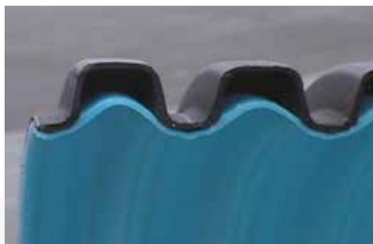
Le tuyau SUPER FLOW conçu pour les canalisations sur des terrains à fortes pentes : la conception structurelle de la paroi intérieure (avec macro rugosité artificielle de type AMR : Artificial Macro Roughness) permet de réduire la vitesse du fluide et de le maintenir dans les marges de sécurité établies. Cela représente des économies importantes sur les coûts d'installation de regard
