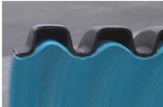
La tubería **SLOW FLOW** está especialmente diseñada para canalizaciones en terrenos con fuertes pendientes: el diseño estructural de la pared interior (con **macro rugosidades artificiales** tipo AMR: Artificial Macro Roughness) permite reducir la velocidad del fluido y mantenerla dentro de los márgenes de seguridad establecidos. Esto supone un importante ahorro en costes de instalación al eliminar o reducir el número de pozos de salto.
