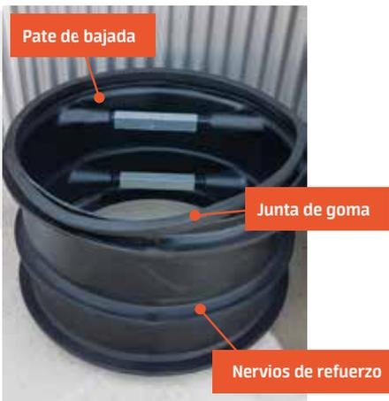
El **T-MÓDULOS** se utiliza en obra para tuberías de grandes diámetros (DN 1000 y DN1200 mm). En este caso en lugar de que la conducción principal entre en el pozo, es el pozo el que se construye sobre la tubería formando un sistema compacto que no afecta al flujo hidráulico.
