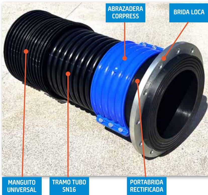
El KIT UNIVERSAL EMBRIDADO es el único sistema de unión del mercado que permite conectar sin soldadura un tubo corrugado con una portabrida PE 100 (RECTIFICADA).
