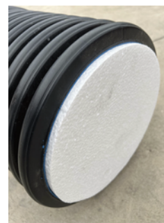
Detalle del relleno de poliestireno en tubo corrugado
